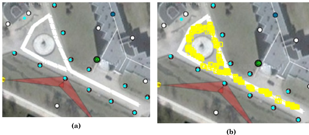
Figura 4.1.7. Ejemplo de Seguimiento de nodo móvil. En (a) trayectoria seguida y en (b) estimación de esa trayectoria mediante un algoritmo de seguimiento.
