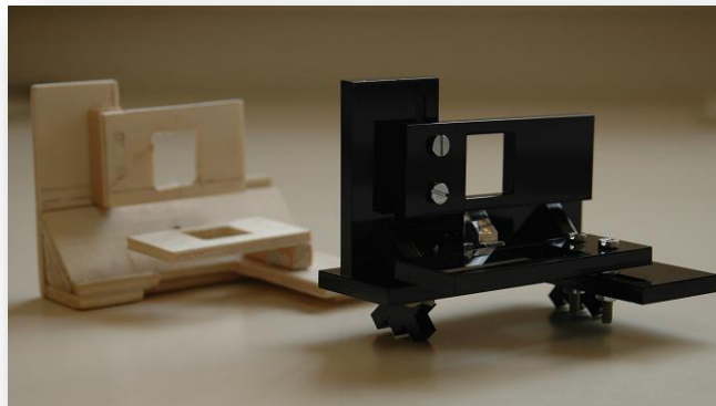
Figura 4.5. Prototipo en madera de balsa y prototipo en metacrilato del soporte de dispositivos para el sistema de correlación con filtro dicroico
