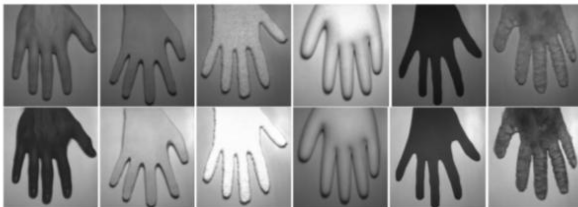
Figura 8.6. Ejemplos de imágenes obtenidas en bandas 1470nm I_{1470}(x_r, y_r) (arriba) y rojo I_{rr}(x, y) (abajo); De izquierda a derecha: mano genuina, arcilla, corcho, yeso, plástico negro y silicona.
