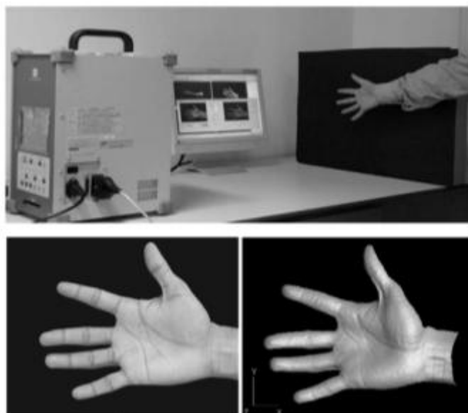
Figura 2.22. Arriba sistema de adquisición de imágenes 2D y 3D, abajo a la izquierda imagen 2D de la mano, abajo a la derecha imagen 3D de la mano [V. Kanhangad et al , 2009].
