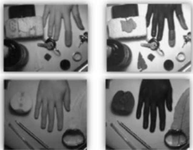
Figura 8.4. Imágenes de la mano y diferentes materiales (Madera, silicona, metal, hojas, plástico,...) Izquierda: banda roja (650nm). Derecha: banda 1470nm.
