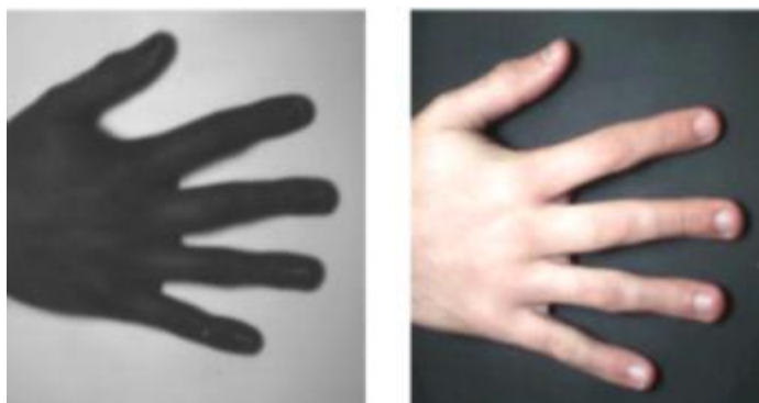
Figura 8.2. Izquierda: imagen en la banda de 1470nm; Derecha: imagen en la banda visible
